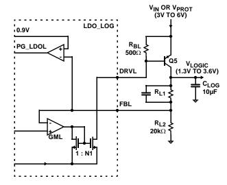
FIGURE 30. VLOGIC FUNCTIONAL BLOCK DIAGRAM
