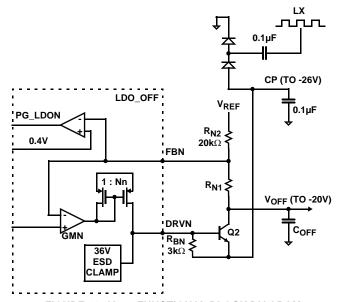
FIGURE 29. V<sub>OFF</sub> FUNCTIONAL BLOCK DIAGRAM
