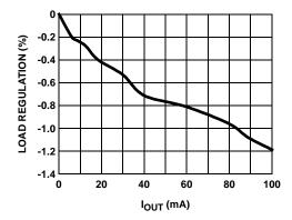
FIGURE 12.  $V_{\mbox{OFF}}$  LOAD REGULATION
