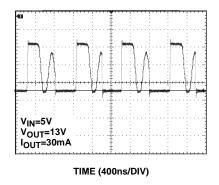
FIGURE 21. LX WAVEFORM - DISCONTINUOUS MODE
