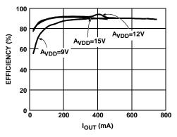
FIGURE 4.  $V_{BOOST}$  EFFICIENCY AT  $V_{IN} = 5V$  (P MODE)
