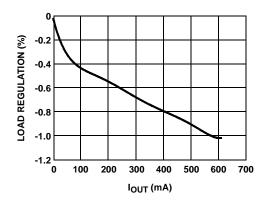
FIGURE 13. V<sub>LOGIC</sub> LOAD REGULATION
