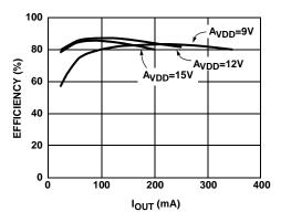
FIGURE 1. V<sub>BOOST</sub> EFFICIENCY AT V<sub>IN</sub> = 3V (PI MODE)
