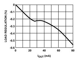
FIGURE 11. V<sub>ON</sub> LOAD REGULATION
