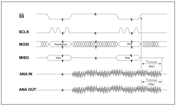
FIGURE 8: PLAYBACK/RECORD AND STOP CYCLE
